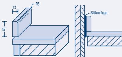
Innen- und Außenecken werden durch Gehrungsschnitte erzielt, geeignet für Endmontage
