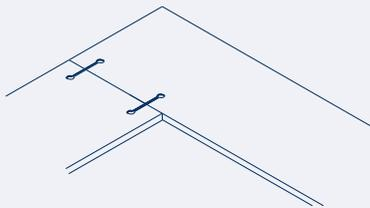
> mit Nut und Feder, Kleber, Spannbeschlag und Schleifmittel für bauseitige Montage EV 01
